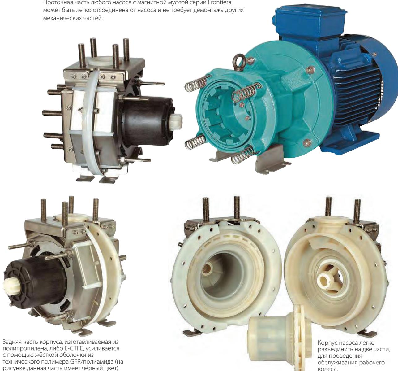
Задняя часть корпуса, изготавливаемая из полипропилена, либо E-CTFE, усиливается с помощью жёсткой оболочки из технического полимера GFR/полиамида (на рисунке данная часть имеет чёрный цвет).
